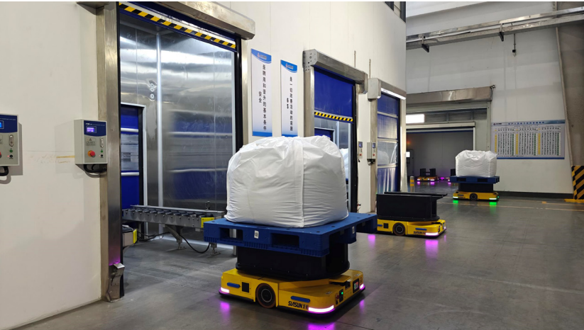
潜叉式自动导引车（AGV）小车
